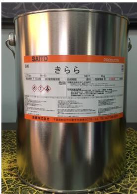
**1)使用方法:**きらら100に対して専用シンナー150~200 **2)硬化時間:**3~4時間(20℃の環境下) **3)試験結果:**①変色は水銀灯下(400w、30cm、100時間照射)において変化なし ②付着強度はゴバン目セロテープ剥離利試験において異常がみられず ③汚染は24時間後の吹きとり滴下試験(食用油、食酢、合成洗剤)において異常なし **4)使用場所:**飲食店舗、高級ブランド雑貨店舗の室内等etc 多くの場所や演出にお使い頂けます。現場塗装が困難な高所や施設や店舗、施工納期が限られている物件において、当社独自品の**特殊**
